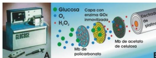
FIG. 2. (A) Fotografia del YSI 23A, primer biosensor comercial de glucosa, i (B) estructura interna del sistema, on es mostra la capa d'enzim immobilitzat entre dues membranes (Mb) [17]
