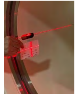
Figura 7. Procés d'alineació amb els làsers.
