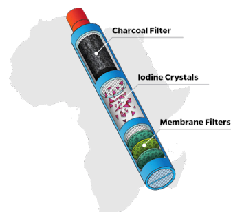
Fig. 3. Estructura interna del The Straw.
