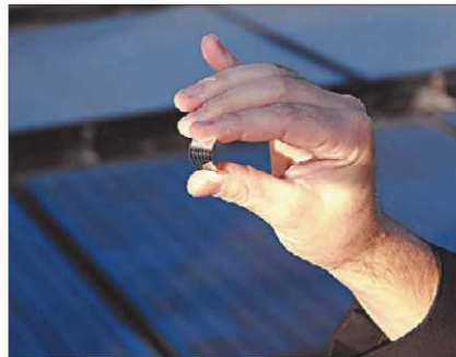
▶ Una cèl·lula solar de material plàstic desenvolupada per l'Institut Tecnològic de Geòrgia, als EUA.
